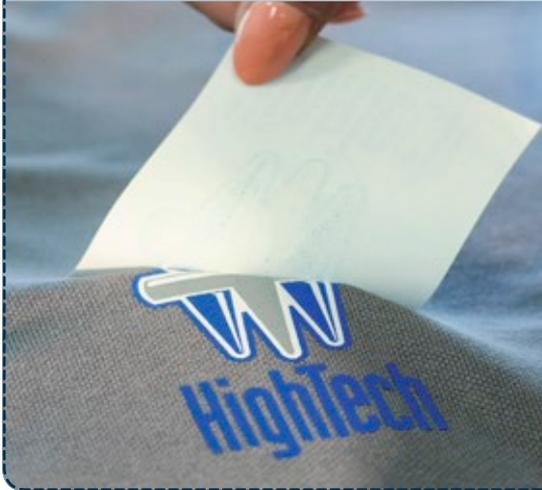
Hierbei wird das Bekleidungsstück kurz vorgeheizt, um die Faser auf die spezielle Veredelung optimal vorzubereiten. Im 2. Schritt wird das Logo mit Druck und starker Hitze aufgebracht.
